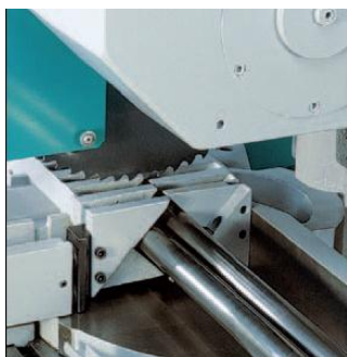
Bild 3 Tillbehör Par av v-backar för buntkapning
