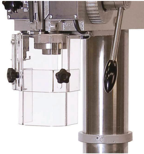
Bild 1. Borrar skydd – Picture 1. Drill guard – Abb. 1. Bohrschutz
