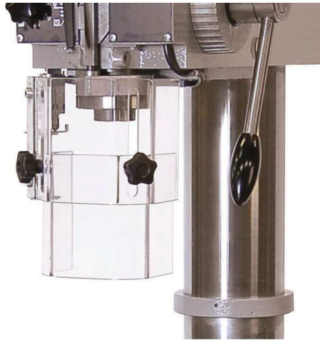
Bild 1. Borrskydd – Picture 1. Drill guard – Abb. 1. Bohrschutz
