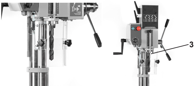
Bild 2a - Bohrschutz (für Maschinen in der EU). Bild 2b - Tiefenmesser (3)
