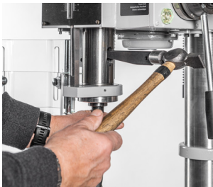
Kuva 15 - Työkalun poisto kiilan avulla
