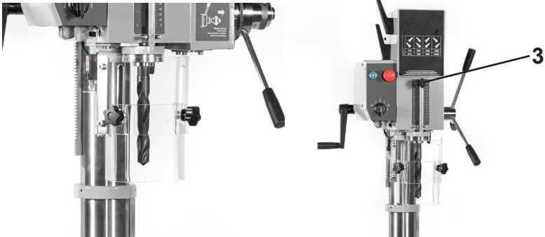
Kuva 2a - Poransuojus (koneisiin EU-alueella). Kuva 2b - Syvyysmittari
