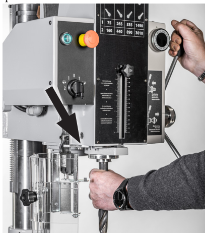
Figure 14 - Expulsion automatique des outils
