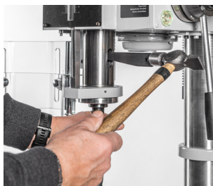
Figure 15 - Expulsion d'outil avec coin
