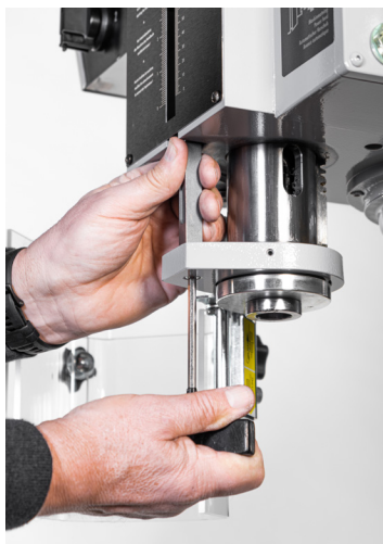
Figura 19 - Rimozione dell'asta di profondità
