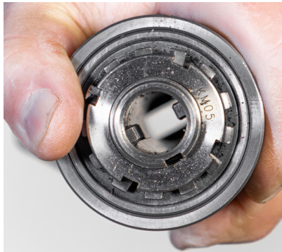
Figura 20 - Dado per la registrazione del gioco dell'albero cavo
