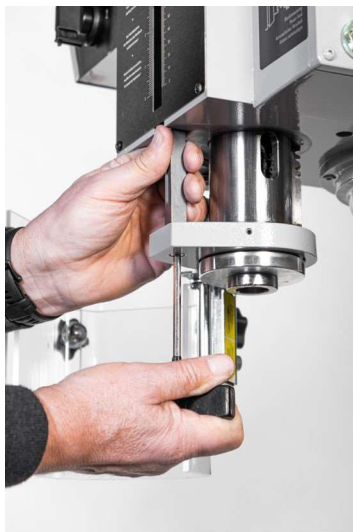
Bild 19 - Die Tiefenmasstange entfernen
