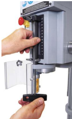
Bild 19 Die Tiefenmasstange entfernen
