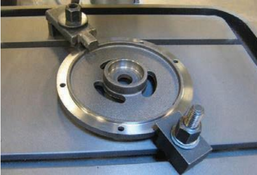
Afb. 4 - Vastzetten van het werkstuk op de tafel, voorbeeld
