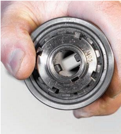
Afb. 20 - Moer om spilspeling af te stellen
