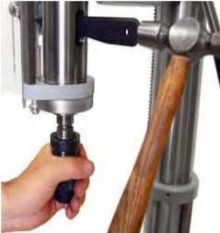
Afb. 15 - Gereedschap loshalen met een spie
