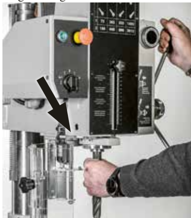
Figur 14 - Automatisk uddrivning af værktøjet
