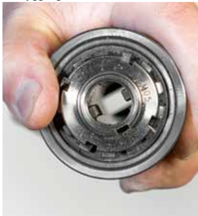
Figur 20 - Møtrik til justering af spindelsslør
