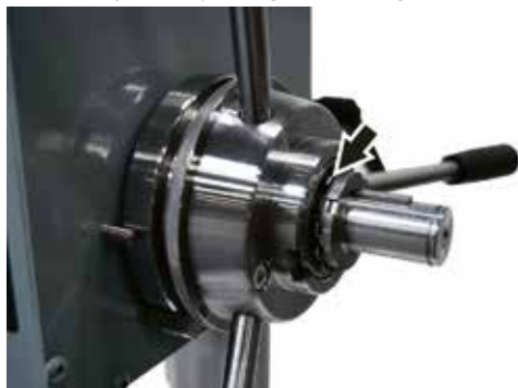
Figur 12 - Justering af fremføringstryk
