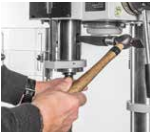
Afb. 15 - Gereedschap loshalen met een spie
