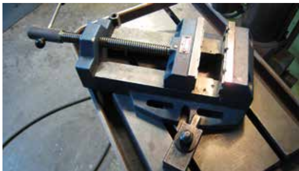
Afb. 3 - Vastzetten van de bankschroef op de tafel, voorbeeld
