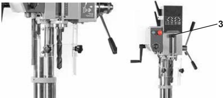
Figur 2a - Borebeskyttelse (for maskiner i EU-området). Figur 2b - Dybdemåling (3)
