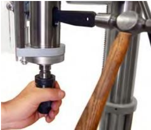
Figur 15 - Verktygsutdrivning med kil
